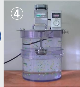
④ 容器の壁面に当たった液流が上と下に分かれて立体的な流れになります。
